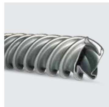
Tube de titane torsadé. Augmente la surface d'échange pour un meilleur transfert de chaleur. Résiste aux produits chimiques présents dans l'eau de piscine.
